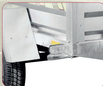
GARDE-BOUE FIXÉ EN 4 POINTS SUR LE CHÂSSIS
