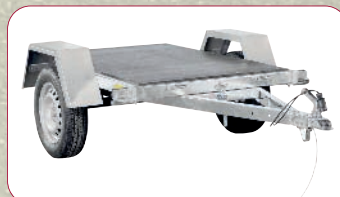
PLANCHER BOIS ANTIDÉRAPANT Toutes les ridelles sont entièrement démontables : plateau / châssis
