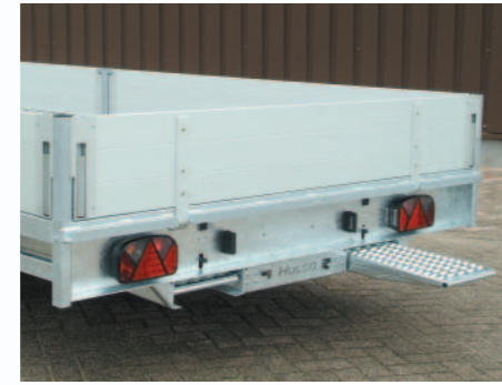
▲ Emplacements pour rangement des rampes sous le châssis
