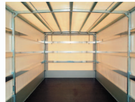
▲ Armatures de la bâche très stables avec les barres aluminium
